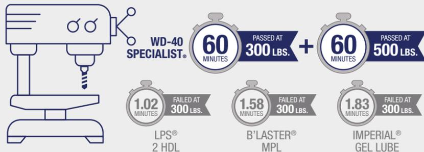
La prueba mide la longitud de la lubricación bajo libras de fuerza antes de la avería. Laboratorio de prueba: Petro-Lubricant Testing Labs (Lafayette, NJ); ASTM D5620; LPS es una marca registrada de Illinois Tool Works Inc., B'laster es una marca registrada de B'laster Chemical Company Inc., Imperial Gel Lube es una marca registrada de Imperial Supplies LLC; Probado 04/2020
