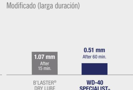
Prueba de desgaste de 4 bolas: Los resultados muestran el ancho de la marca después de 60 minutos a 12.000 RPM.
